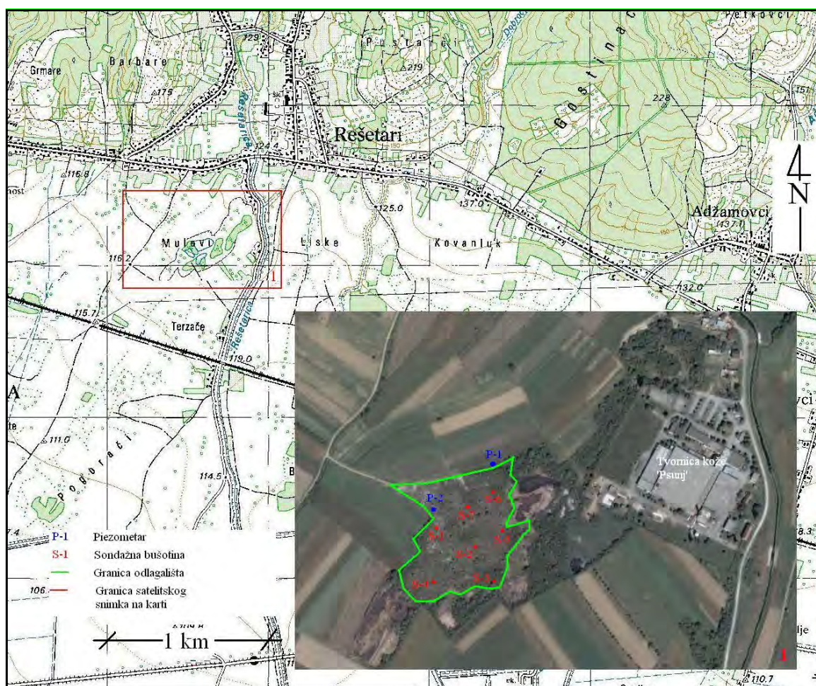
Slika 10. Položaj piezometara (P1 i P2) označenih plavom bojom i sondažnih bušotina S1-S7, označenih crvenom bojom.
